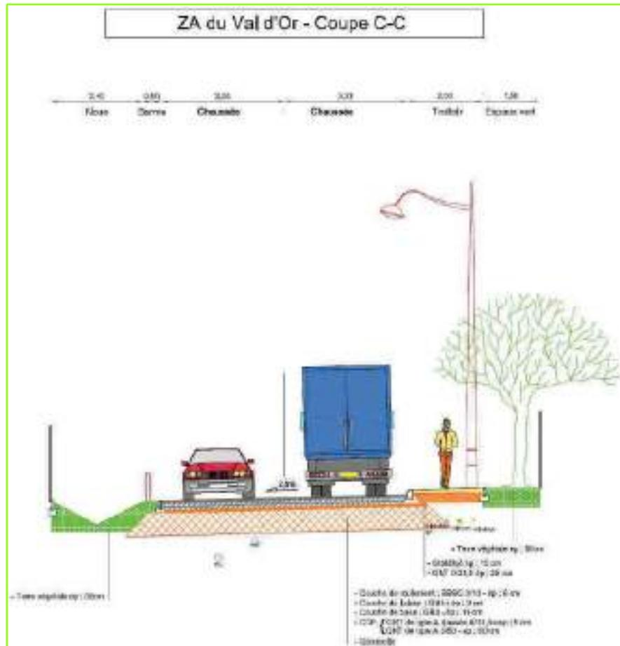
Figure 17 : Profil en travers type de la voirie au droit de l'extension
